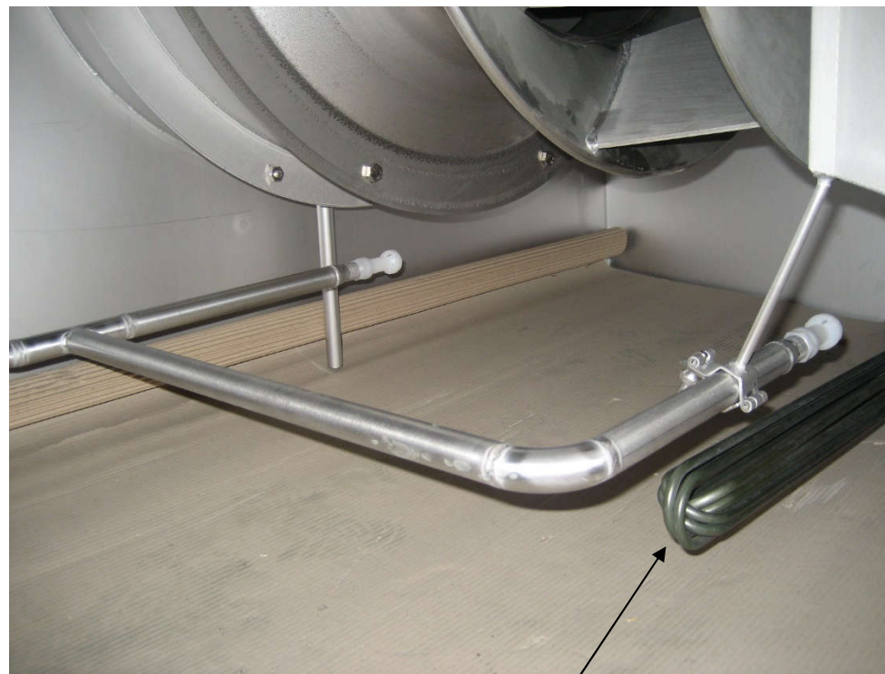
Сеть форсунок CIP под колесом из нержавеющей стали и погружным электронагревателем
